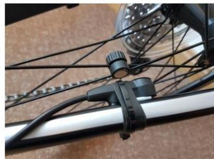
Le câble du capteur de vitesse doit être connecté avec le câble « jaune » provenant du moteur :
