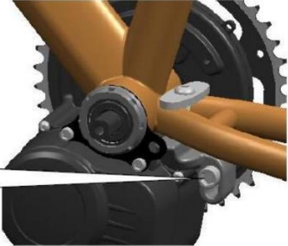
À l'aide d'une clé Allen de 6 mm, serrez le boulon à environ 10 Nm
