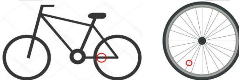
Si vous constatez qu'il n'y a pas assez d'espace entre le cadre et les rayons pour monter le capteur, celui-ci peut être retiré du support et fixé directement sur le hauban à l'aide de serre-câbles.
