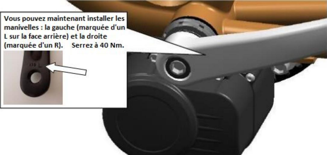
Vous pouvez maintenant installer les manivelles : la gauche (marquée d'un L sur la face arrière) et la droite (marquée d'un R). Serrez à 40 Nm.
