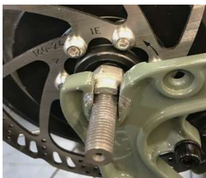
Positionnement correct coté frein
